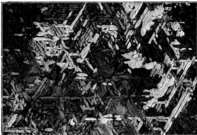
Slika 90. Izpodnebno železo iz Toluke, oglajeno in izjedkano, po Fickerju.
